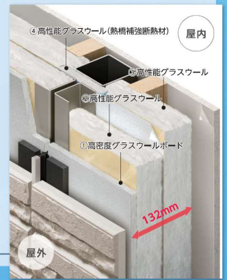
外張り断熱通気外壁 概念図
