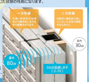
外張り断熱通気外壁 遮音概念図
